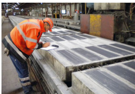
Semelles sous traverse ECOVIB® USP : la méthode spéciale de liaison par adhérence.
