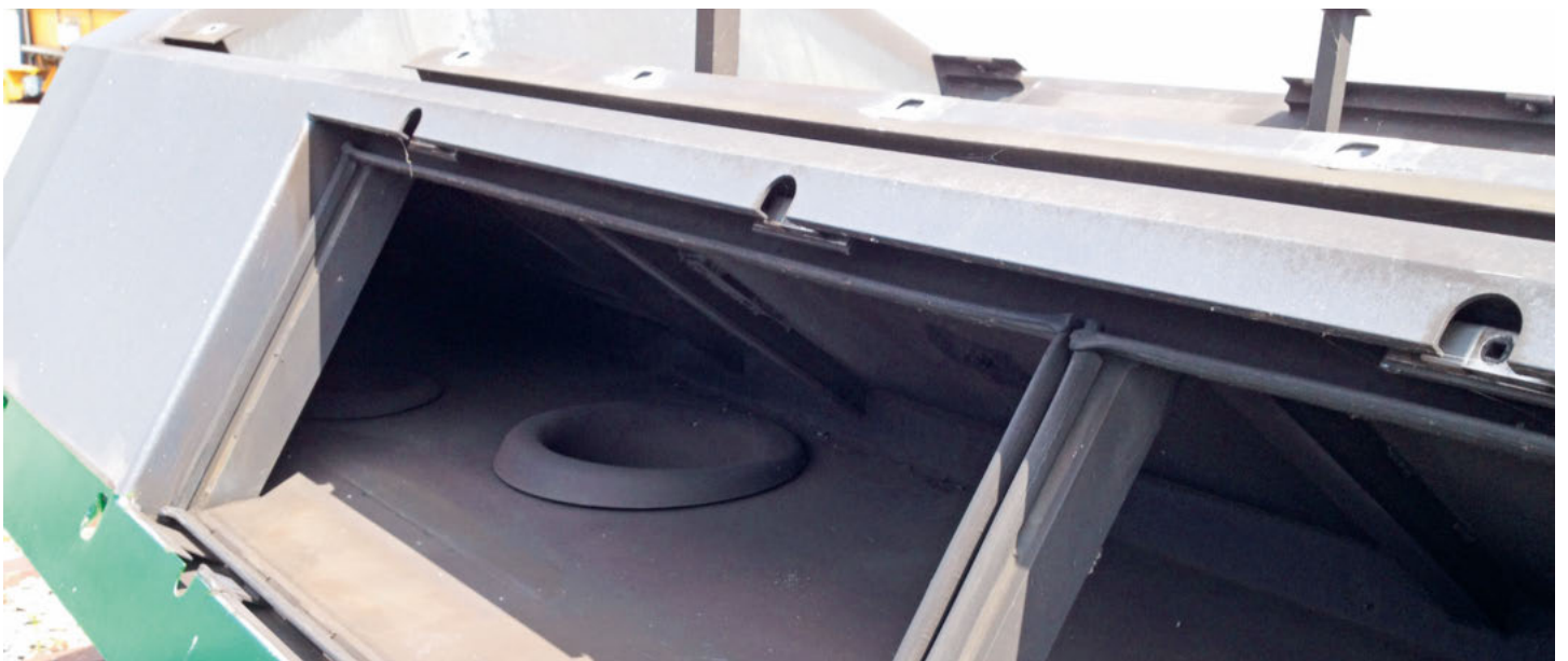
La toiture des locomotives doit être complètement démontée pour la révision. On y aperçoit les profils d'origine qui devaient être coupés à la bonne longueur et collés dans les coins du cadre.
